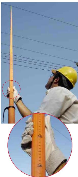
As VTT-1/2 a VTT-1/9 poderão ser fornecidas, com graduações métricas, tornando a vara de manobra telescópica uma ferramenta para medições de espaçamentos verticais.
